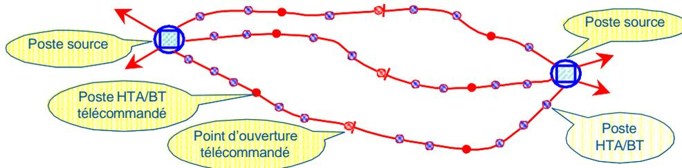
Figure 5 : exemple de structure en coupure d'artère
