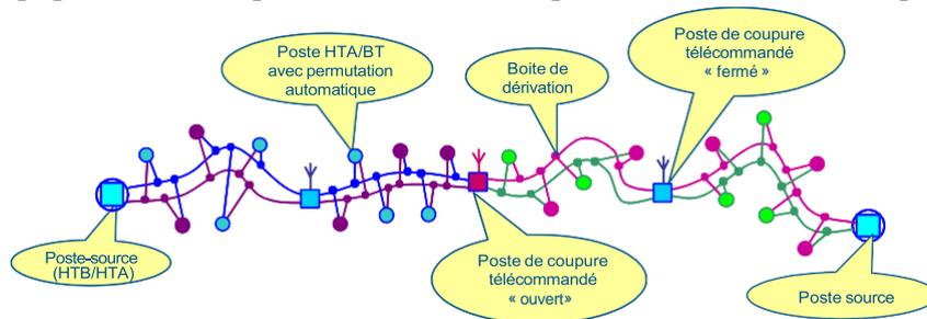
Figure 6 : exemple de structure en double dérivation
