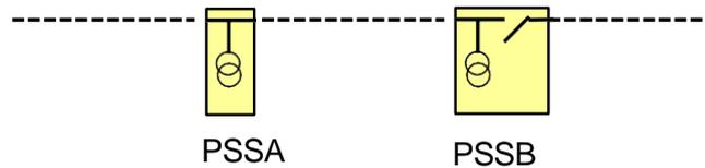
Figure 12 : Schéma non admis (2 tangentes successives sans coupures)
