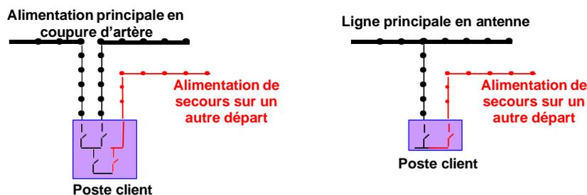
Figure 15 : Schémas d'alimentation pour une alimentation de secours
