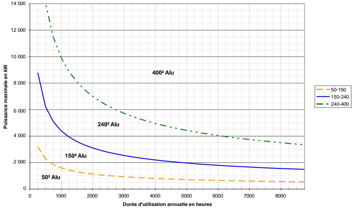
Figure 9 : Abaques des sections économiques de câble (ne prenant pas en compte les intensités admissibles)
