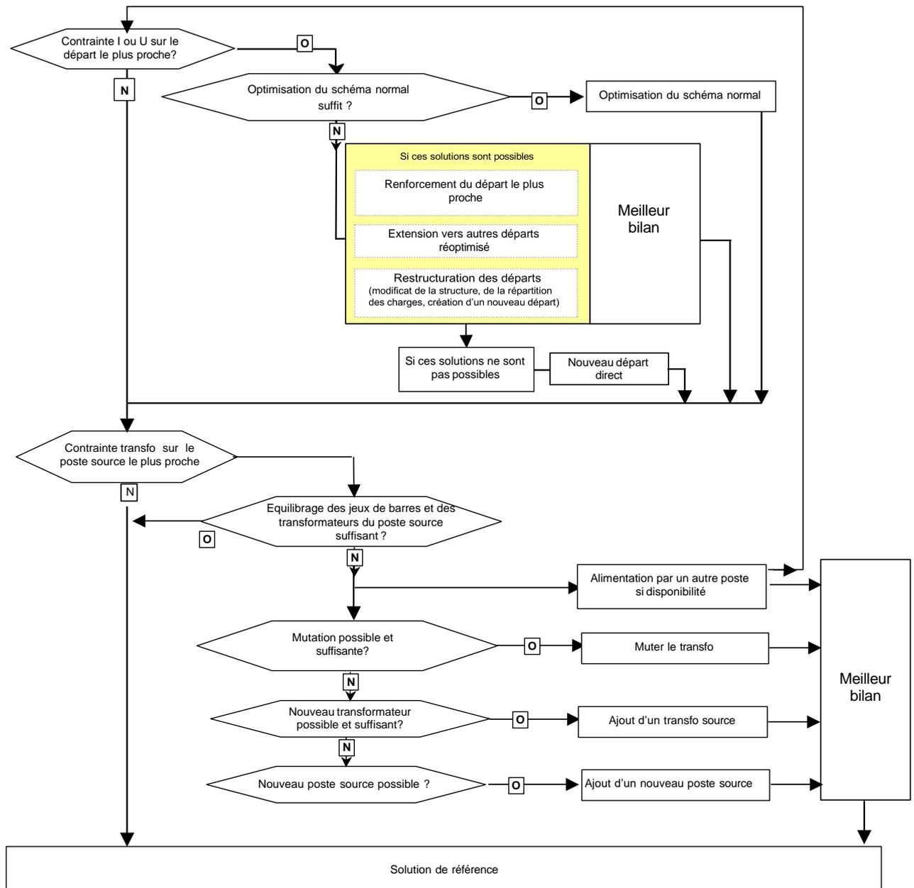
**Figure 10 : Principe de levée de contrainte après raccordement**
