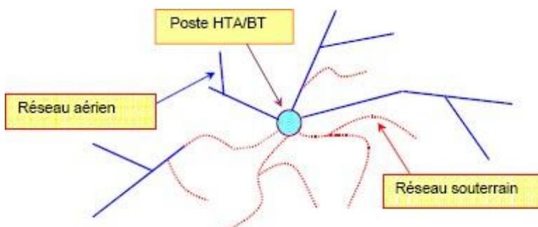
Les réseaux BT peuvent être réalisés en lignes aériennes (autoporté) ou en câbles souterrains. Les contraintes électriques imposent une section minimale de conducteurs à respecter. Les sections à utiliser pour le réseau BT sont :
