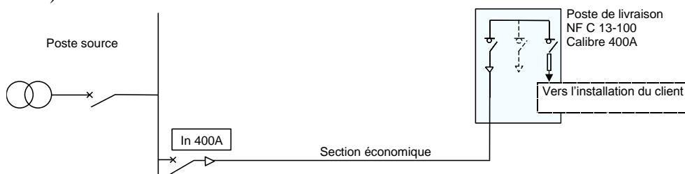
Figure 2 : Schéma de raccordement des sites de puissance de raccordement inférieure à 12 MW
