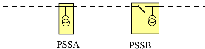
Figure 13 : Schéma correct (coupure entre les deux tangentes)
